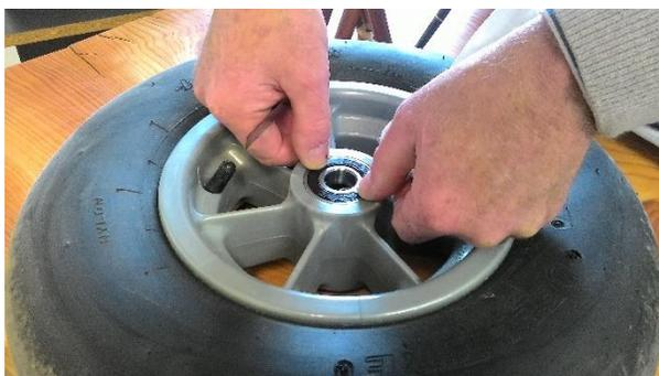
Après le long de stockage, il arrive que le roulement soit bloqué. Si le roulement est bloqué, mettez du dégrippant et débloquez le noyau pour remettre le roulement en rotation. Ensuite, remplissez le de graisse remettez de joint de spi.
