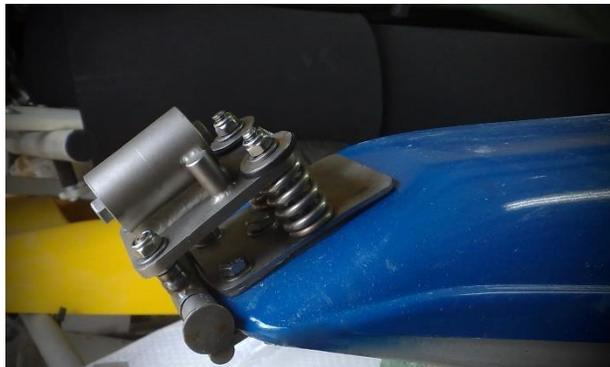
Les axes de roues et la boulonnerie doivent toujours être humectés d'huile ou graisse (pour éviter le sable et le sel de sécher dans le pas de vis).
